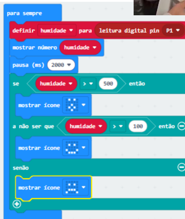
Programação Micro:bit utilizada para medir a humidade do solo
